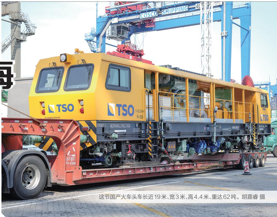
这节国产火车头车长近19米、宽3米、高4.4米、重达62吨。胡嘉睿 摄
