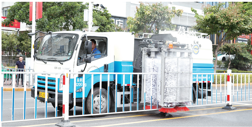
新型护栏清洗车正在进行清洗作业。记者陈理杰摄
