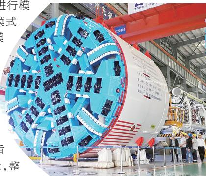
厦门地铁首台“土压-TBM双模”盾构机。
