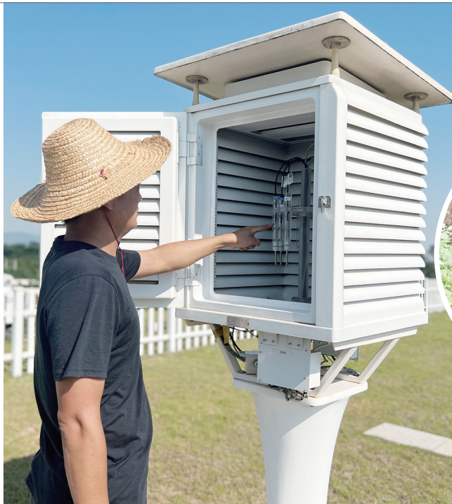
百叶箱内设置了三根铂电阻气温传感器,实时监测气温。记者 洪艳艳 摄
