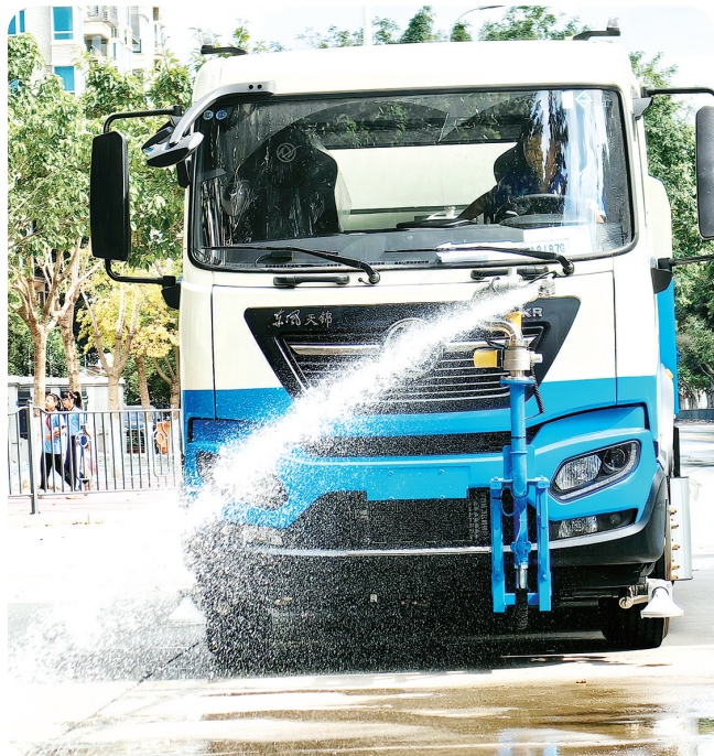
水炮可大幅旋转的洒水车清扫更高效。
