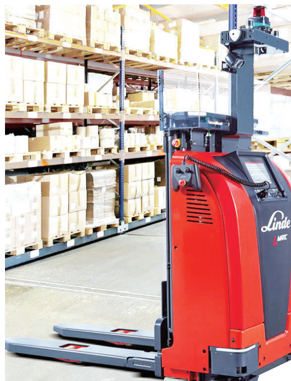
林德紧凑型托盘搬运机器人能精准高效完成搬运与堆垛作业。
