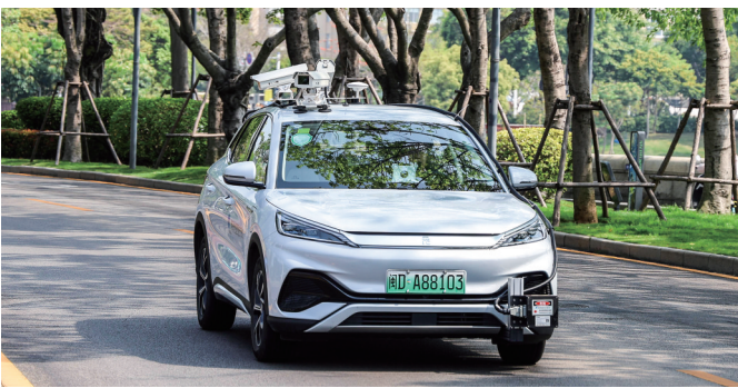
巡查车车顶加装了北斗定位、激光平整度仪等设备。
